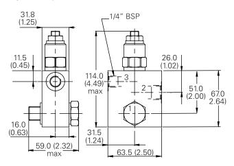
Complete Valve - Gasket Mounted 3/8" Ports Basic Code 1CEG35/1CEBG35/1CERG35/1CELG35
